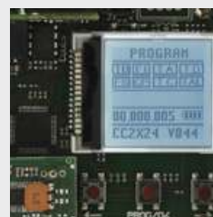
ZELFLERENDE PROGRAMMATIE DANKZIJ EEN LCD DISPLAY BLEGOS / BLESOL / BL224E / BLA24LREV
